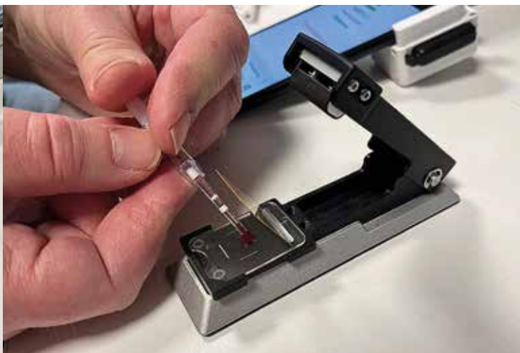
Blodet påføres et testkort med nanosøyler som gjør det mulig å «printe» flere analyser på samme kort.
