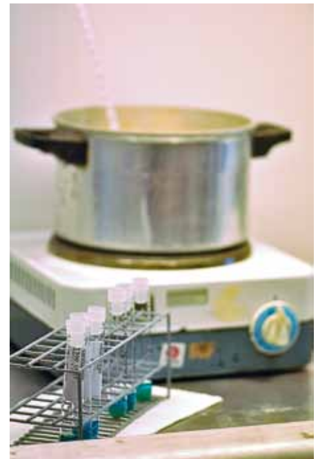
Benedicts test er en enkel og gammel metode som bioingeniørene finner hensiktsmessig for å eliminere de urinprøvene som ikke krever sukkerkromatografi. Prøvene varmes opp på kokeplaten i bakgrunnen.
