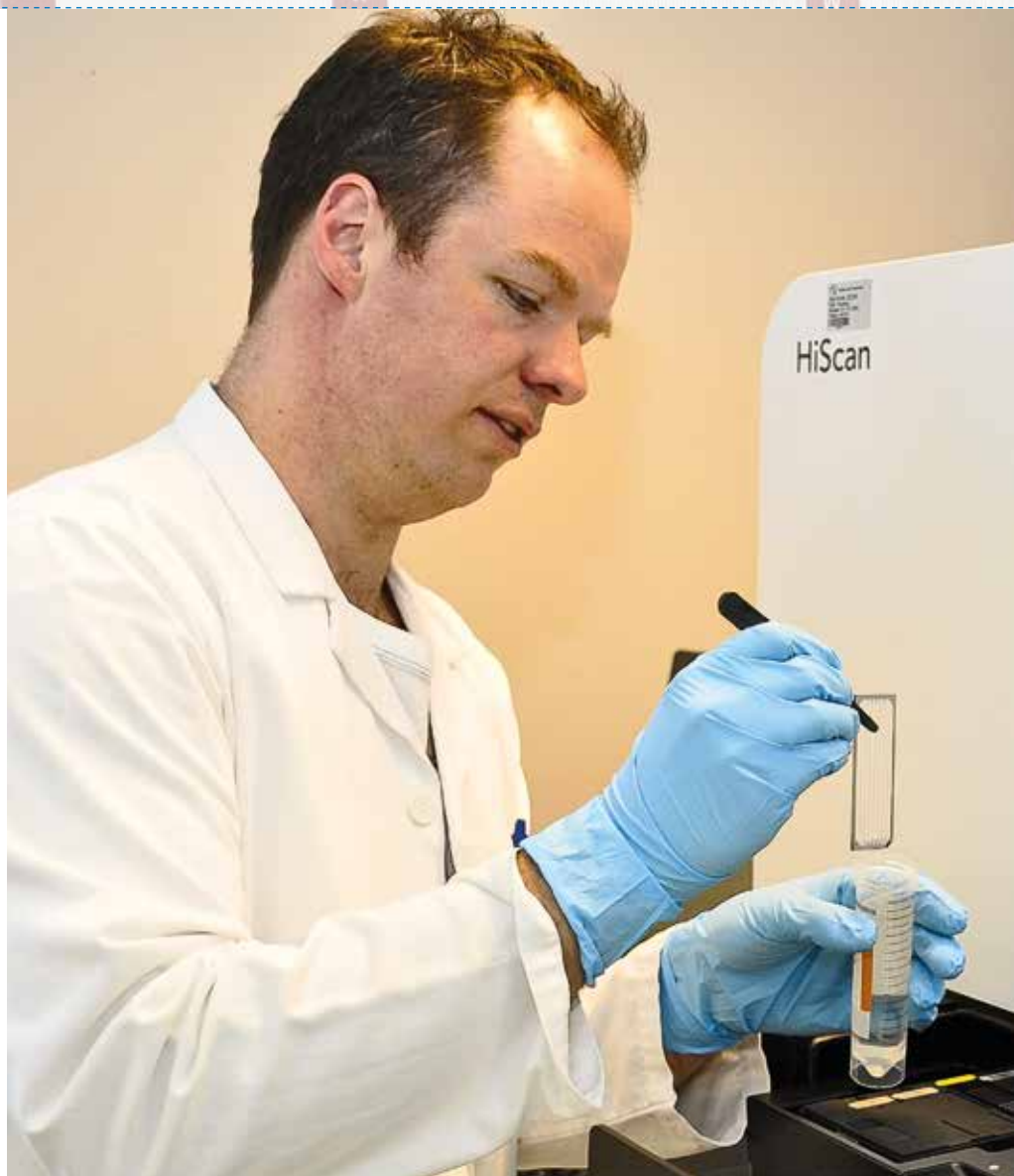
Det hender at Øyvind Busk kjører HTS-maskinen. Her holder han flowcellen som instrumentet leser sekvensen blir avlest som én av fire farger. Fargekartene blir senere omgjort til DNA-sekvenser.
