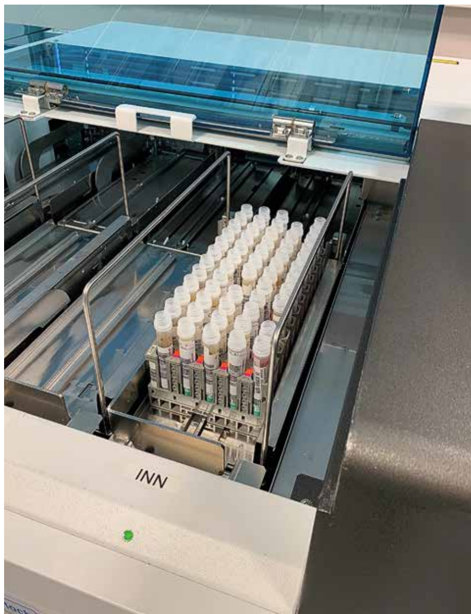
Prøver klar til analysering vert lasta direkte på cobas 8000.
