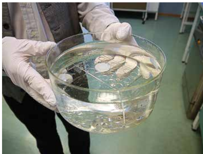
Et diffusjonskammer i sin enkleste form. Plassert i springvann, et tilnærmet naturlig miljø for vannbakteriene.
