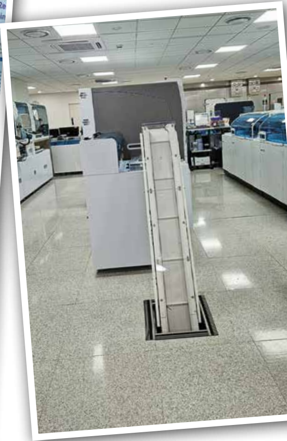
Samlebåndet som frakter prøver til automasjonen går ned i gulvet.
