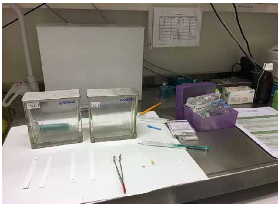
FIGUR 4. Utstyr til Thin Layer Chromatography (TLC), som benyttes til kvalitetskontroll av radiofarmaka.
